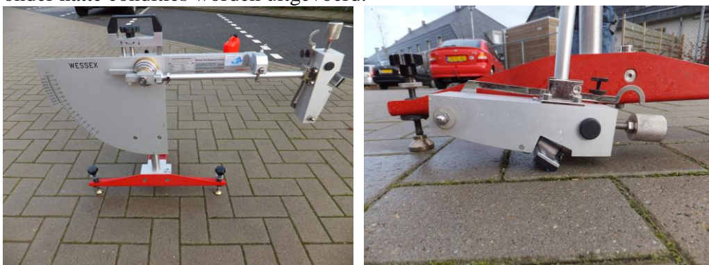
Figuur 3 SRT in startpositie voorafgaand aan meting en SRT-voetje op wegoppervlak
