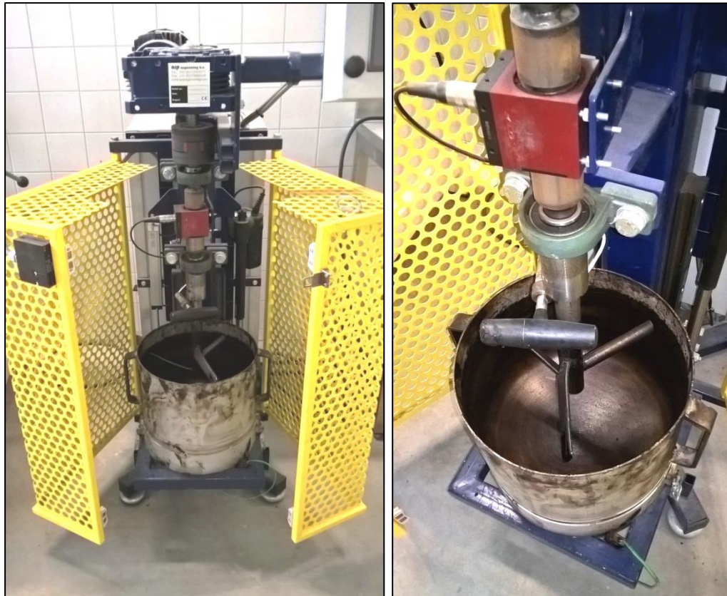
Figuur 2: Links – Boskalis prototype verwerkbaarheidsmeter 2016; Rechts – Detailopname meetopnemer en mengarm 2016
