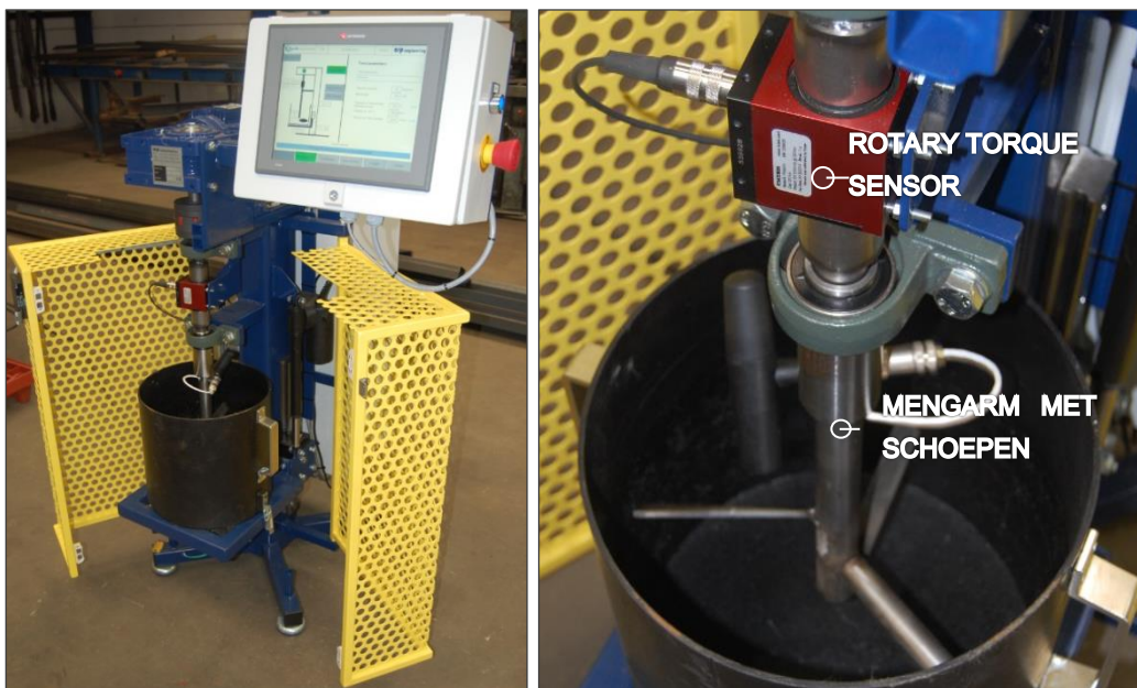
Figuur 1: Links – Boskalis prototype verwerkbaarheidsmeter 2014; Rechts – Detailopname meetopnemer en mengarm 2014
