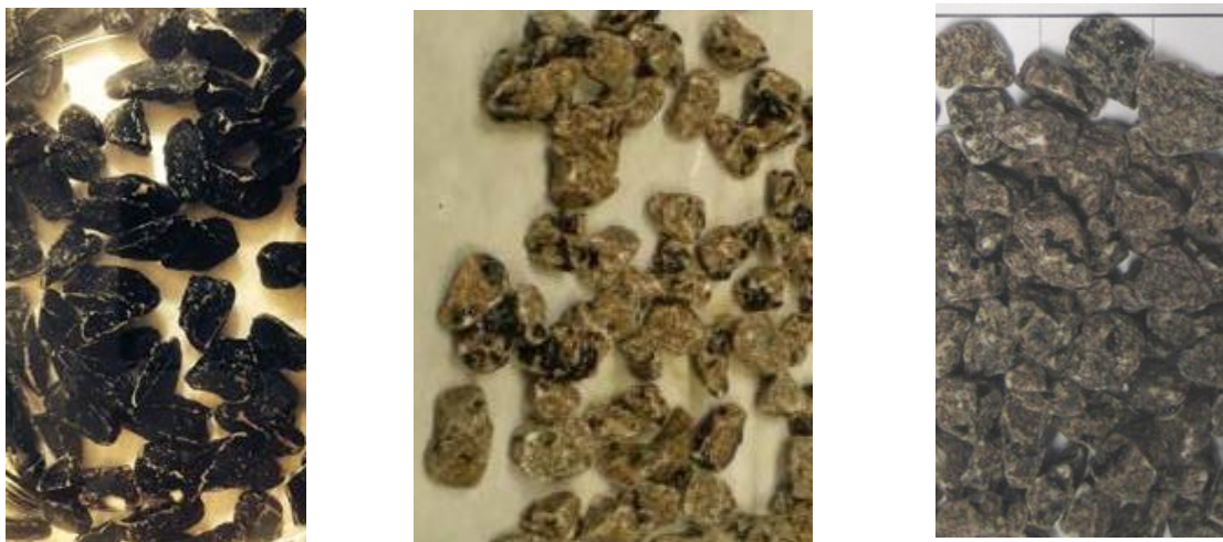
Figuur 4. Rolling Bottle resultaten van Graniet met PmB na 24 uur. Van links naar rechts: lab 3 met 40% bedekking; lab 4 met 20% bedekking en lab 1 met 5% bedekking.
