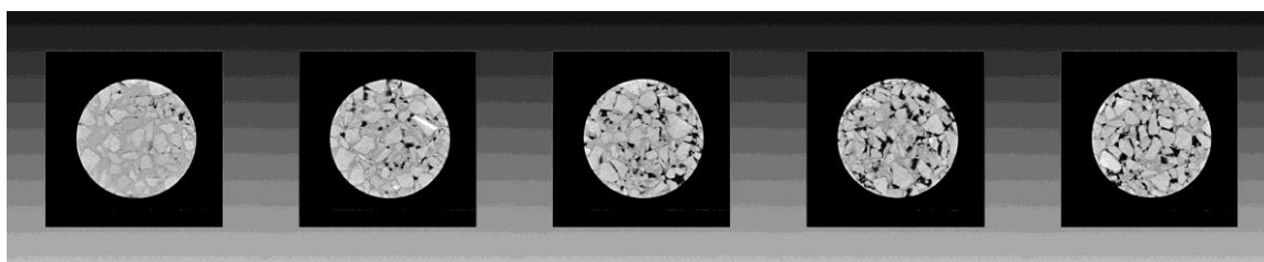
Figuur 7. CT scans van gevulde ZOAB. Van links naar rechts: 0, 5, 10, 20, en 30 mm onder het oppervlak van ZOAB.
