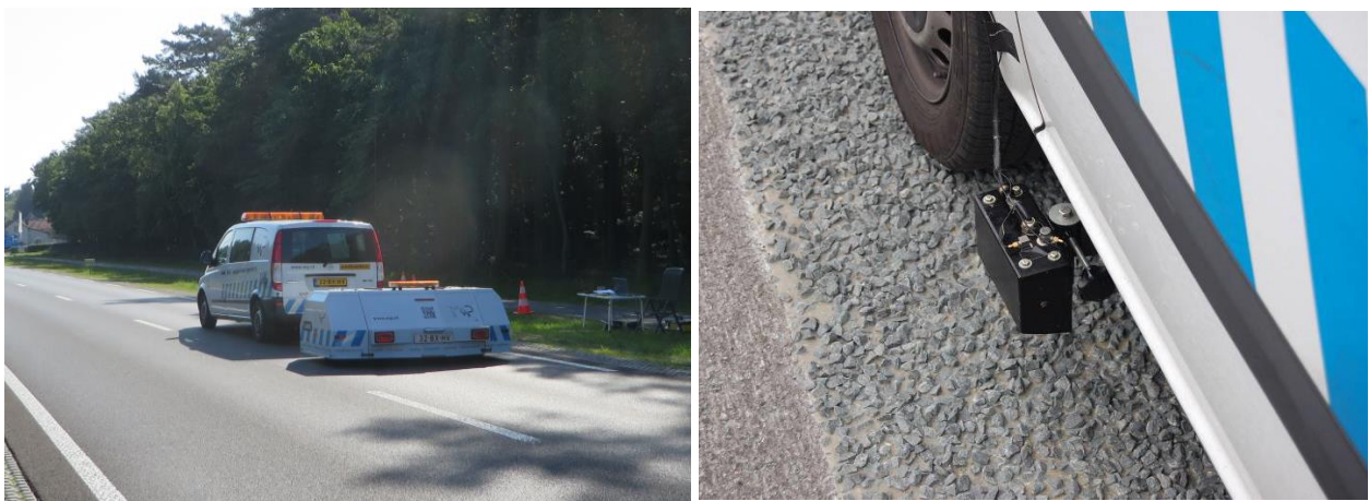
Figuur 5. Links de CPX-meetaanhanger in bedrijf, rechts een laserhoogtemeter gemonteerd op het voertuig
