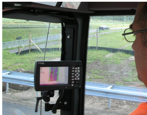
fig. 2; De machinist krijgt realtime informatie tijdens de verdichting fase.
