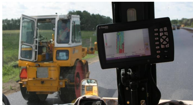
Fig. 1: wals werkgangen in kleuren weergegeven.
