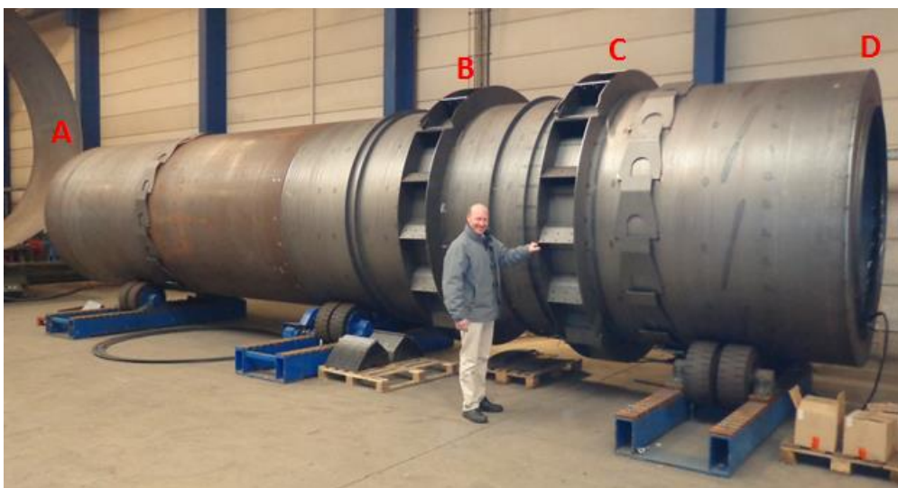
Figuur 3: De witte trommel met 2 extra zij-inlaten voor de dosering van PA-stone.
