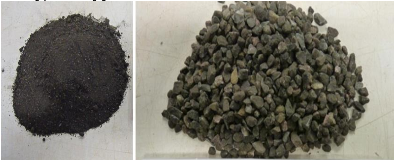
Figuur 2: Componenten van asfaltgranulaat na behandeling in de rotatiescheider: links de mastiek en rechts steenslag 11/16.
