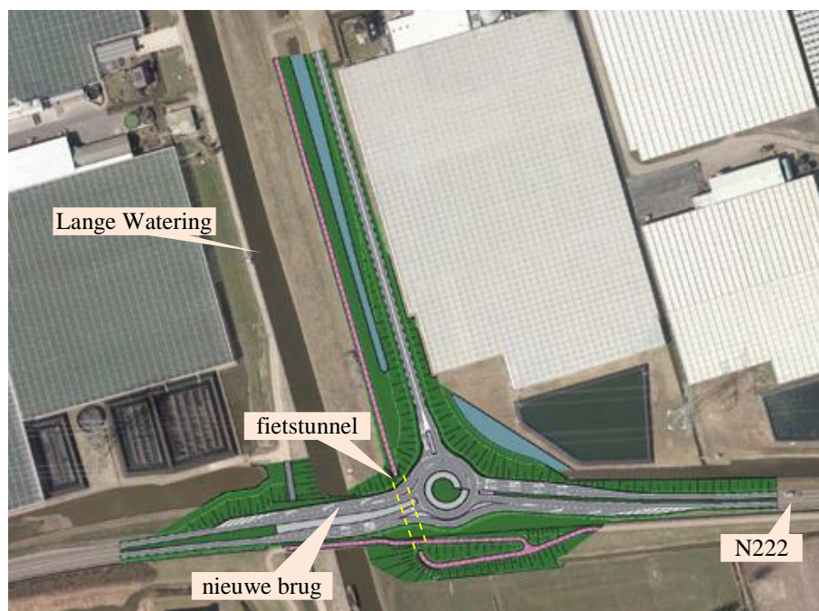
Figuur 1 De gerealiseerde dubbelstrooksrotonde tussen de ontsluitingsweg Waringveldse Polder en de N222
