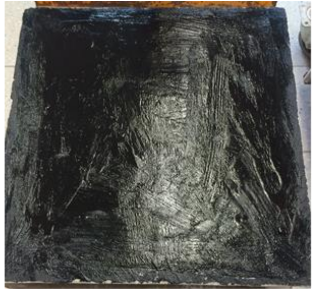
Figuur 1 en 2: Betonnen plaat 3 weken na productie en aangebrachte primerlaag
