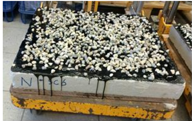
Figuur 3 en 4: Bitumenmembraan op constructie en afstrooilaag.
