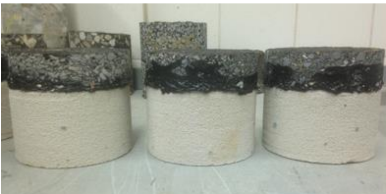
Figuur 5 t/m 6: Proefstukken na boren en proefstuk na testen bij KOAC-NPC.
