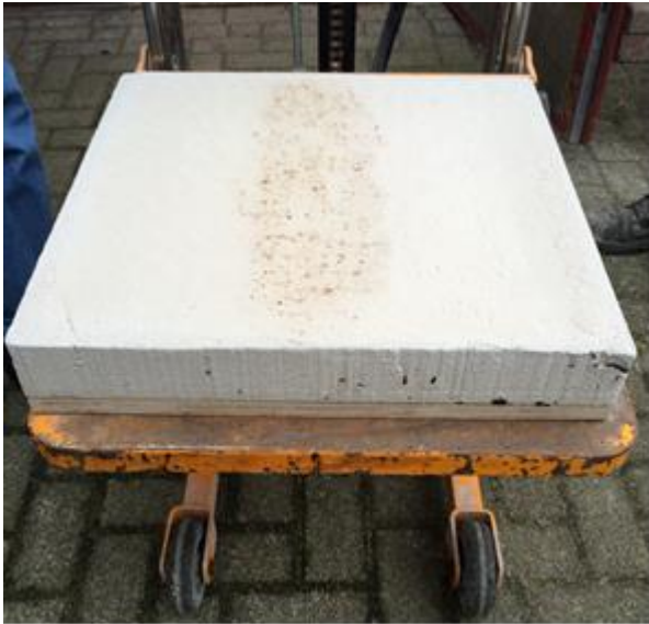
Figuur 1 en 2: Betonnen plaat 3 weken na productie en aangebrachte primerlaag
