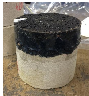
Figuur 5 t/m 6: Proefstukken na boren en proefstuk na testen bij KOAC-NPC.
