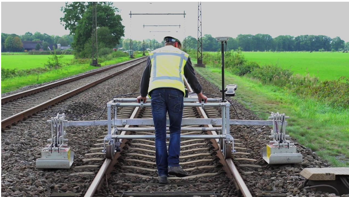
Figuur 3. Twee grondradar sets aan weerszijden van een lorrie.
