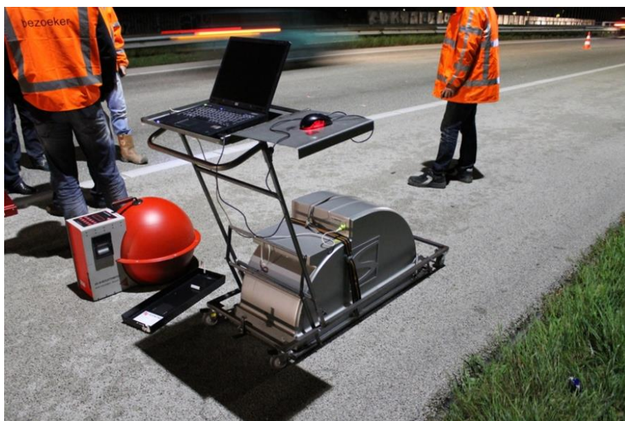
Figuur 7 Nachtzichtbaarheid bij openbare verlichting (gem. luminantiecoëfficiënt Q_0 -S1).
