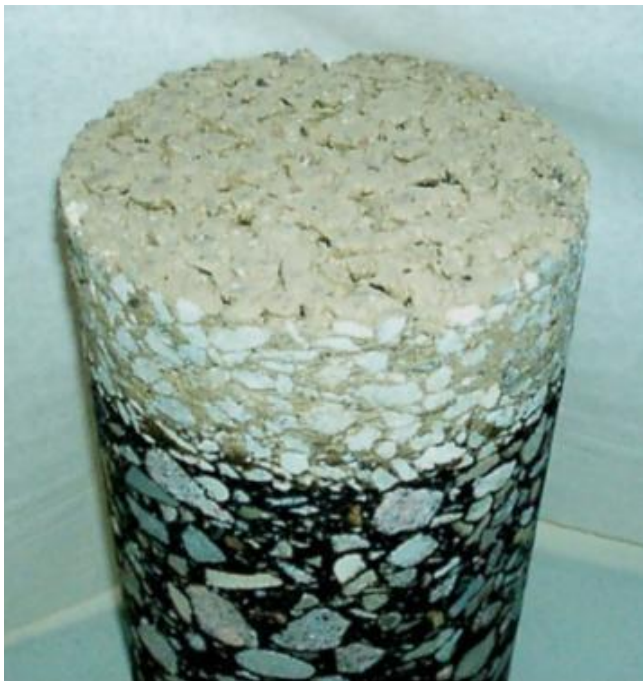
Figuur 8 Lichtgekleurd asfalt met blank bindmiddel (en pigment) zichtbaar aan oppervlak.
