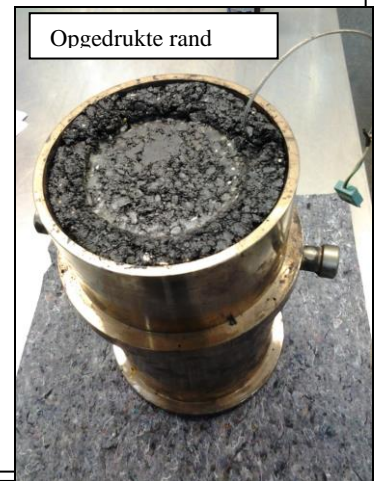
Figuur 7 De 150mm mal na de test met de indrukking door de 100mm bovenplaat. De temperatuursonde is rechtsboven zichtbaar
