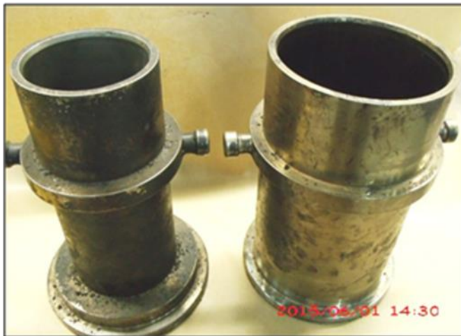
Figuur 4 t/m 6 100 en 150mm gyratormal en daarboven de bijbehorende bovenplaten.
