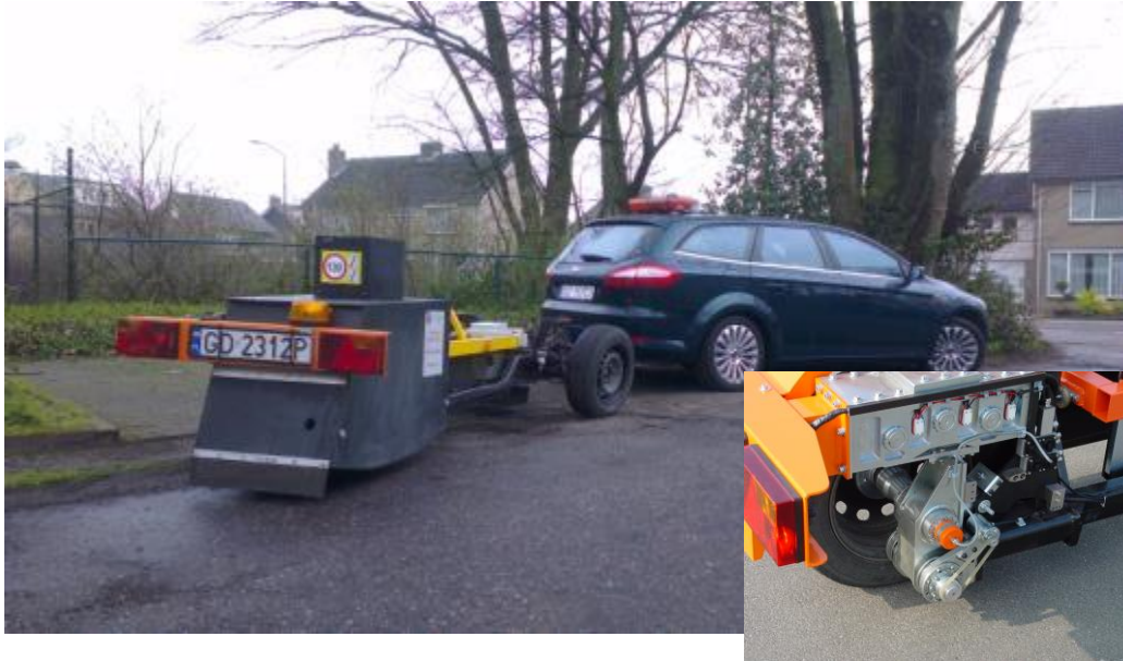
figuur 1 De TU Gdansk trailer voor het uitvoeren van rolweerstandmetingen. De gedetailleerde foto laat de bevestiging van de meetband zien
