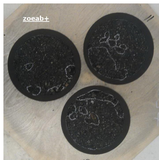
Foto: RSAT platen na beproeving voor onbehandeld en behandeld met ZOEAB+
