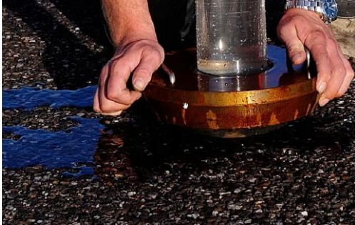
Foto: Waterdoorlatendheid oud ZOAB, water stroomt meer zijwaarts dan verticaal naar beneden
