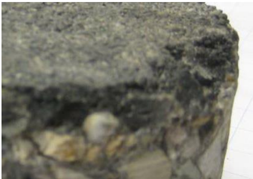
Foto a -detail boorkernrand ZOEAB (beschadigd door loslatende steen uit ZOAB) Foto b -detail boorkernrand ZOEAB+ (gave rand)
