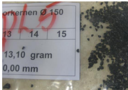
Foto: detail vrijkomend materiaal bij RSAT platen na beproeving voor onbehandeld en behandeld ZOAB
