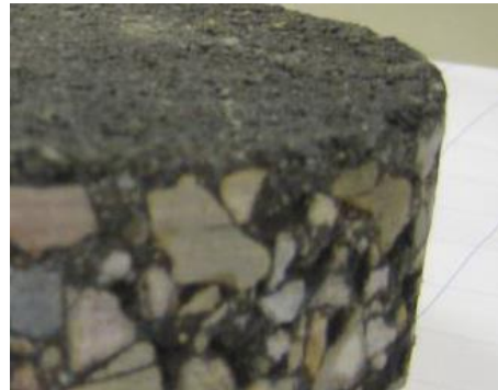
Foto a -detail boorkernrand ZOEAB (beschadigd door loslatende steen uit ZOAB) Foto b -detail boorkernrand ZOEAB+ (gave rand)
