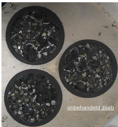
Foto: RSAT platen na beproeving voor onbehandeld en behandeld met ZOEAB+
