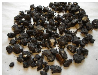
Oud asfaltgranulaat -110 °C
