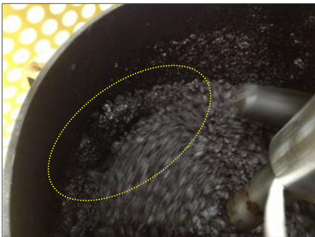
Figuur 9 : Afzetting van fijn materiaal tegen wand mengkom
