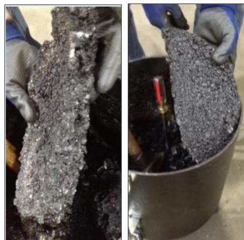
Figuur 10 : Laagdikte van aangekoekt fijn materiaal
