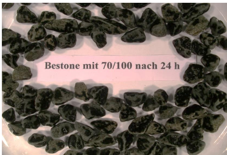
Figuur 3 Bestone met 70/100-bitumen na 24 uur Rolling Bottle Test
