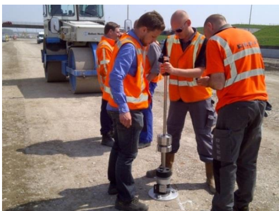
Figuur 6 Uitvoering LWD-meting op puinbaan
