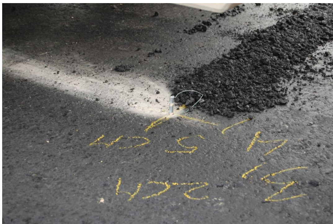
Figuur 10: Thermokoppel vóór aanbrengen van het te beproeven mengsel
