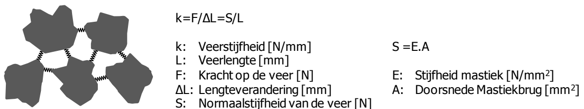
Figuur 3. Een simpel model ziet ZOAB als steentjes die met veren onderling verbonden zijn. De mechanische impedantie wordt verminderd als de veerstijfheid “k” kan worden teruggebracht.
