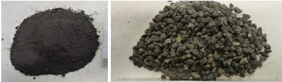
Figuur 2. Door frees te scheiden komen nieuwe grondstoffen beschikbaar. Links: Freeszand \leq 2\text{ mm} . Rechts: bijna schone steen \geq 2\text{ mm} , gezeefd in fracties.
