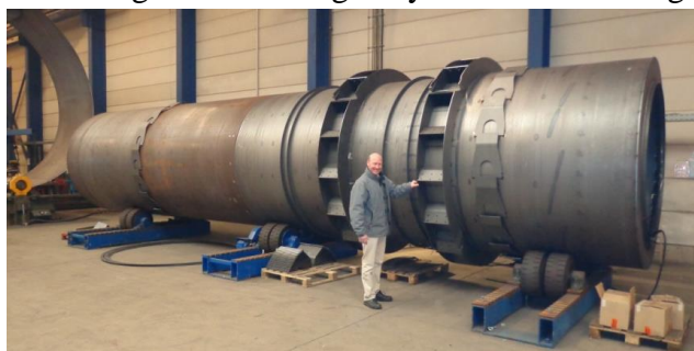
Figuur 4. Met een speciale trommel is ervaring opgedaan bij het gebruik van teruggewonnen steen voor de productie van nieuw asfalt.
