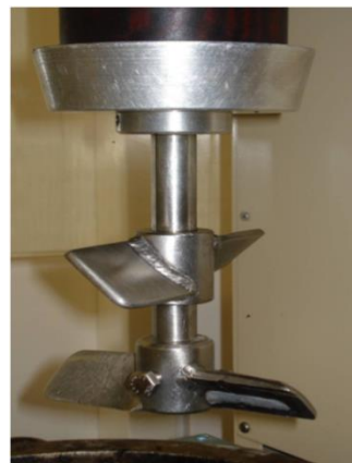
Figuur 3: Opstelling verwerkbaarheidstest IFM-VIS-GA (Prof. Schellenberg)
