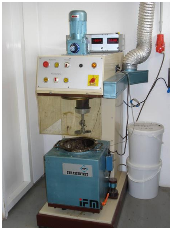
Figuur 3: Opstelling verwerkbaarheidstest IFM-VIS-GA (Prof. Schellenberg)
