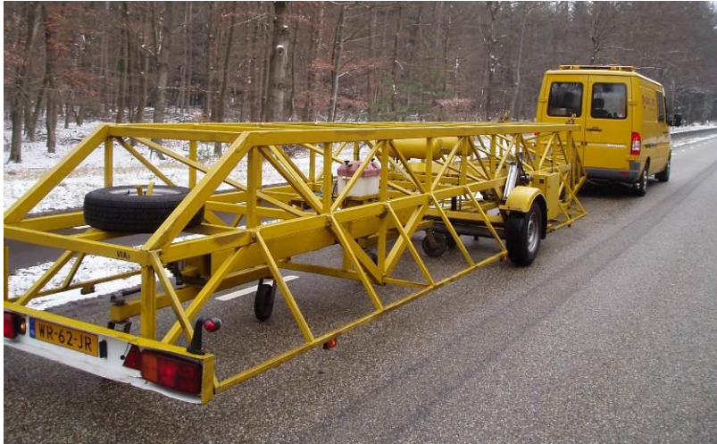
Figuur 2 Viagraaf van KOAC•NPC tijdens meting
