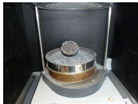
Figuur 6a (links) en 6b (rechts): 6a: het oppervlak van een in het lab behandelde proefstuk en 6b de behandelingsmethode "schuren".
