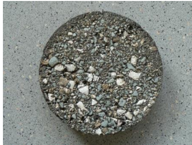
Figuur 7): Het oppervlak van een laboratorium kern na behandeling van het oppervlak. In het oppervlak zien we enige ontmenging, met name AC Surf mengsels zijn hier gevoelig voor.
