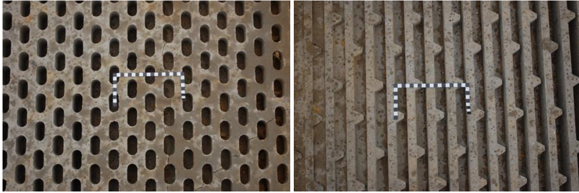
figuur 3 Afbeelding van de twee concepten diffractoren. De linker afbeelding toont concept 1 en de rechter afbeelding concept 2
