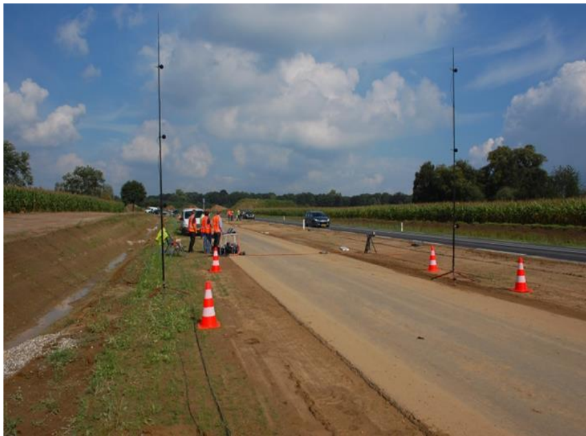
figuur 2 Afbeelding van een meetdoorsnede voor het meten van het effect van de diffractor
